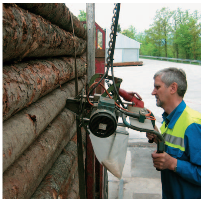
> Die sorgfältige Spanentnahme ist entscheidend für die Genauigkeit der Gewichtsvermessung.
