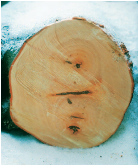
> Trennschnitt zu nahe am Zwiesel!
