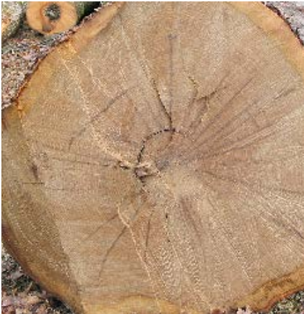
Spinnerin (Eiskluft) und Ringschäle bei Eiche
