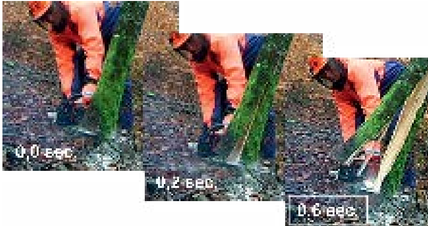
Aufreißen des Stammes bei falscher Schnitttechnik
